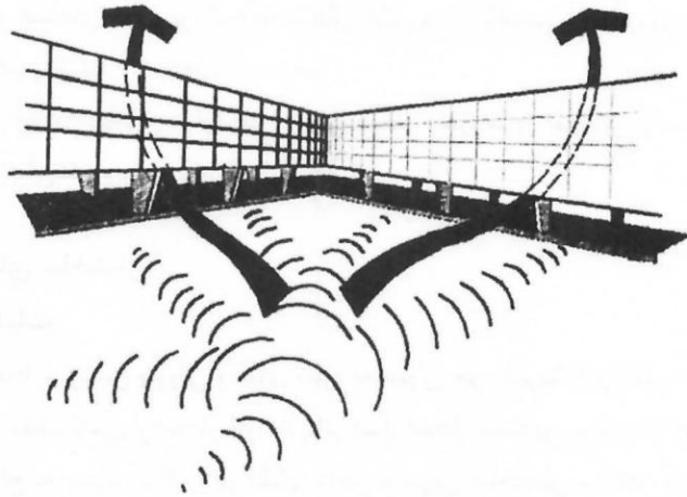
شکل ۲-۲۱-۵- تخلیه موج انفجار از پیلوت باز
