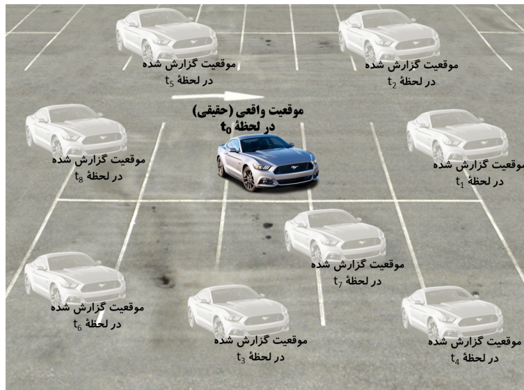
شکل (۱۴-۲۶) تصویری از آنچه که در عمل و با استفاده از داده‌های فروبی گزارش شده توسط یک گیرنده ثابت GPS در طول زمان رخ می‌دهد.
