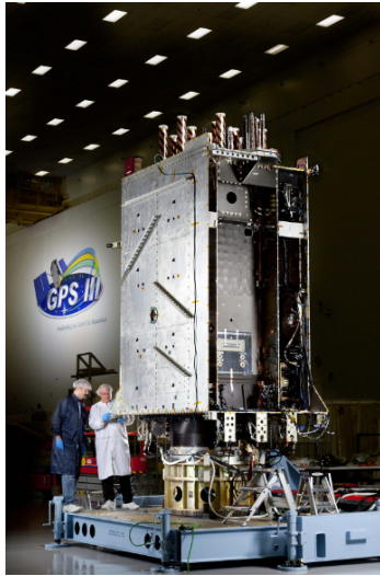
شکل (۲-۱۸) سمت راست: تصویری از یک ماهواره GPS نسل دوم و اجزای تشکیل دهنده آن؛ سمت چپ: تصویری از یک ماهواره GPS نسل سوم؛ به ابعاد و اندازه این ماهواره در مقایسه با اندازه دو مویچک مویچک در کنار آن توجه نمایید.
