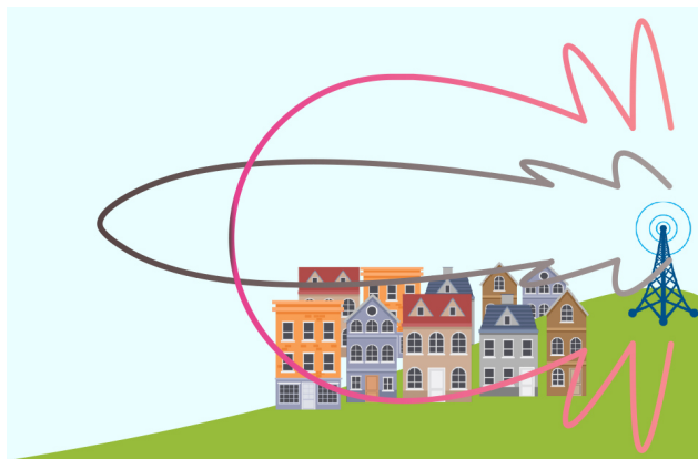
شکل (۵-۶) سمت راست: تصویری از یک آنتن جهت دار، یا در اصطلاح Directional، سمت چپ: شماتیکی از الگوی تابش یک آنتن جهت دار
