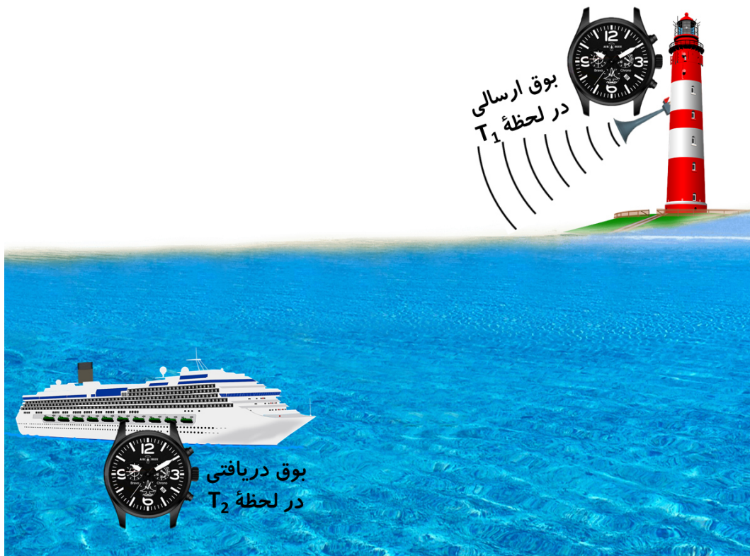
شکل (۳-۵) دریافتی و ارسالی بوق دریاوردی را در نظر بگیرید که می‌خواهد از یک بوق دریایی برای موقعیت‌یابی خود استفاده نماید؛ فرض بر این است که ساعت مورد استفاده در شناور، از انطباق بسیار دقیقی با ساعت موبود در بوق دریایی برخوردار است؛ صوت ایجاد شده توسط بوق دریایی در لحظه T_1 ، پس از طی مسیر واسط میان بوق دریایی تا شناور، در لحظه T_2 بر روی شناور، شنیده (دریافت) خواهد شد.
