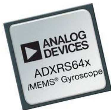
شکل (۱۲-۱) سمت راست: شماتیکی از یک جایروی نرفی با فناوری فیبر نوری و با کاربرد فضایی و با فضای دررفت (شناوری) بسیار اندک و در مرتبه 1 \text{ Arcsec/hr} سمت چپ: شماتیکی از یک جایروی نرفی با فناوری MEMS.
