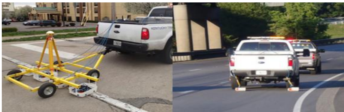
شکل چهار: تجهیزات GPR مورد استفاده برای اسکن تونل Gap کامبرلند.
