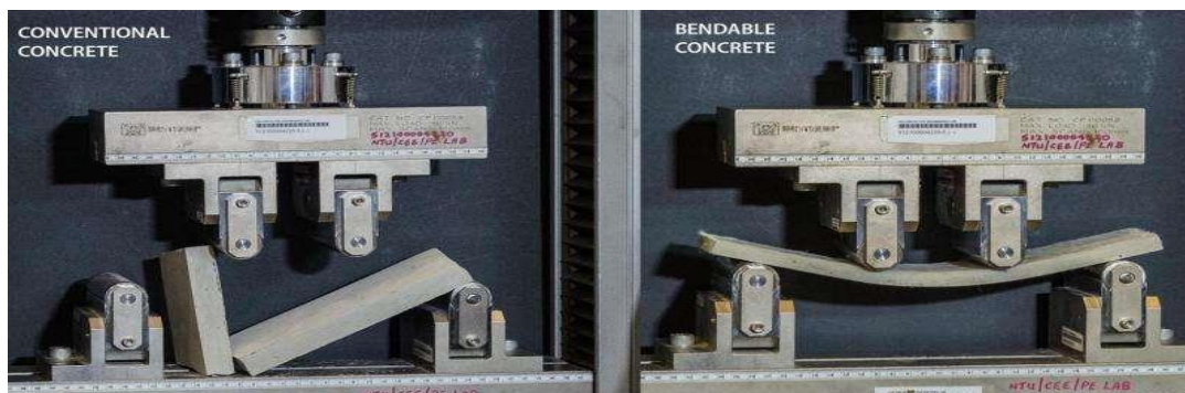
بتن معمولی در مقابل بتن خم شونده ایجاد شده در NTU. اعتبار و صاحب امتیاز: دانشگاه صنعتی Nanyang
