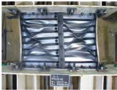
شکل ۲۶. عکس دیوار برشی با ورق موجدار (چپ) و چارت یا نمودار بار-تغییر شکل با خاصیت جذب انرژی عالی
