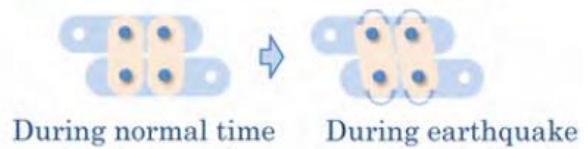
شکل ۲۴. میراگر اصطکاکی دورانی
