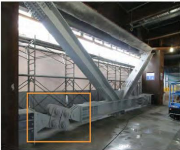
شکل ۲۴. میراگر اصطکاکی دورانی
