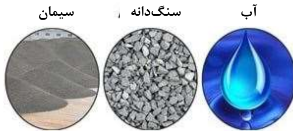
شکل ۳: مواد تشکیل دهنده بتن مسلح
