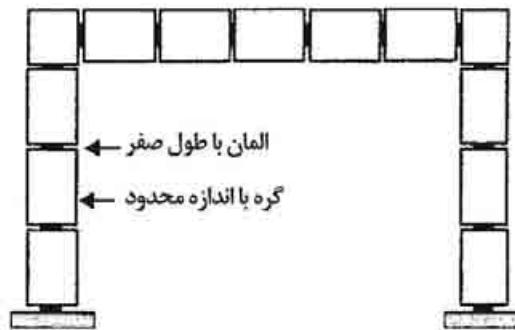
شکل ۲-۹ مدل المان‌های کاربردی برای یک قاب
