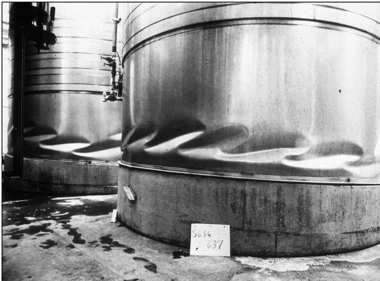
شکل ۱-۱۵ کمانش موضعی ورق استوانه جدار نازک
