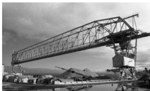
شکل ۷. جرثقیل پلی با اعضای قطری و پخش کننده‌های بار در پایین
