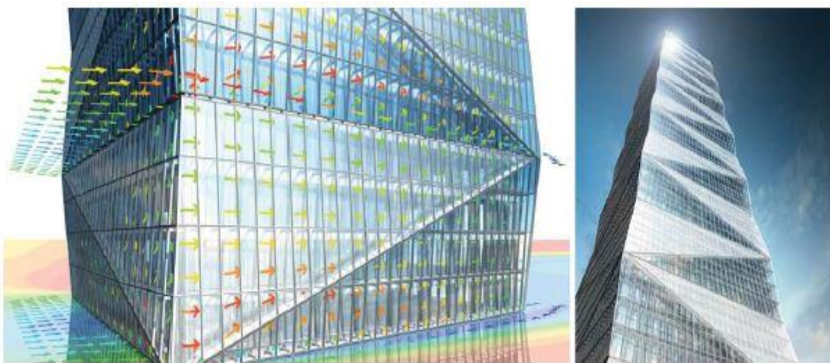
شکل ۹. تهویه باد در دیوار دوگانه برج Jinao
