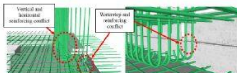
شکل ۲: مدل سه‌بعدی اتصالات پیچیده با انکرها، آب‌بندها و میلگردها.
