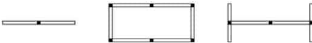
شکل ۲. پایدارسازی با اندرکنش قطعات پیش‌ساخته دیوار
